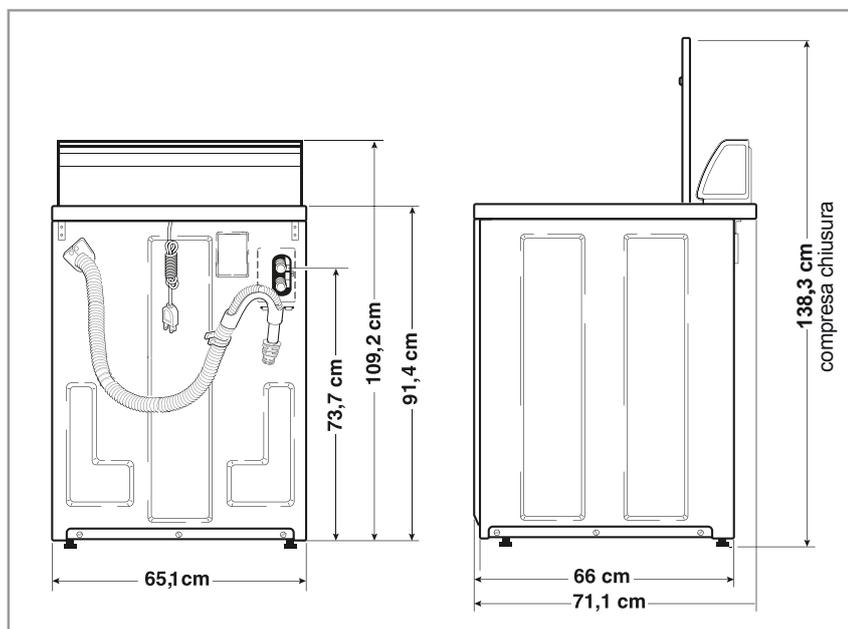
**NOTA:** La presa dello scarico deve essere in grado di accettare un tubo di scarico di diametro esterno minimo di 32 mm (1 pollice e 1/4). Altezza consigliata 90 cm.
